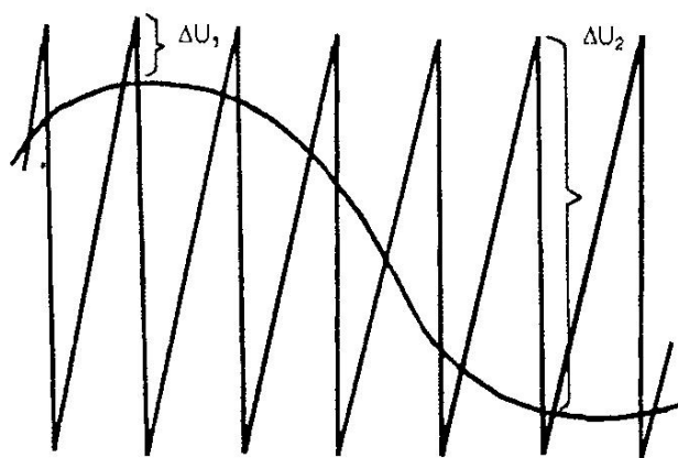
Рис. 2.24. Перепад напряжений на входе компаратора
